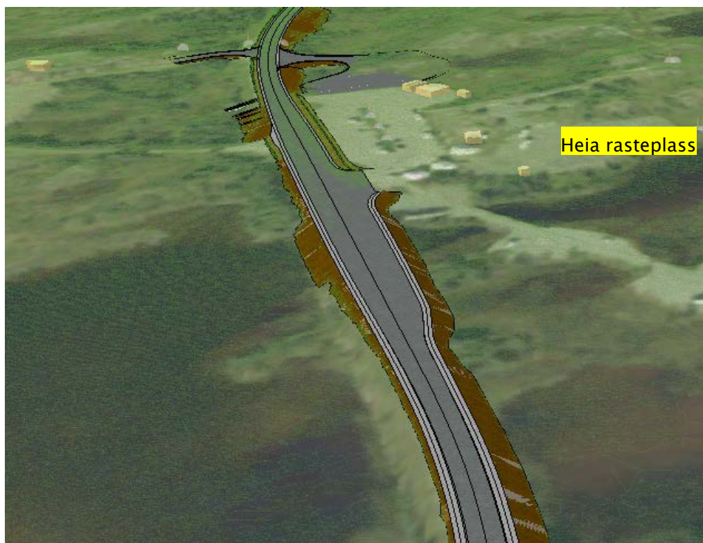
Figur 22 viser avkjøringa til kollektivholdeplassen som skal samlokiseres med rasteplassen
